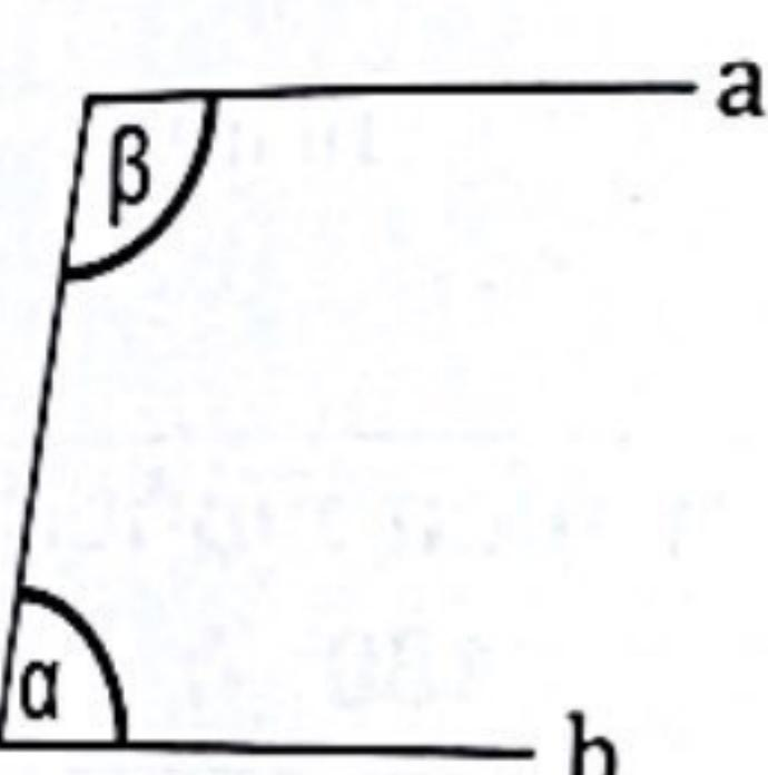
3. האות  $C$  שברטוט נוצרה על ידי היסרים  $a$  ו-  $b$  המקבילים זה לזה והנחתכים על ידי ישר שלישי כלשהו. הזווית  $a$  ו- $\beta$  שברטוט הן זוויות חד-צדדיות, لكن הן משלימות זו את זו ל- $180^\circ$ , כלומר:  $180^\circ = \beta + a$ . כדאי לזכור כי האות  $C$ , כורתה שני ישרים מקבילים הנחתכים על ידי ישר שלישי, חושפת זוויות חד-צדדיות.
